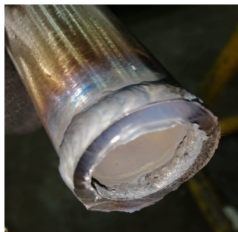
Рисунок 2 – Фото корня шва при плохой защите корня шва от окисления с образованием «ежиков»
