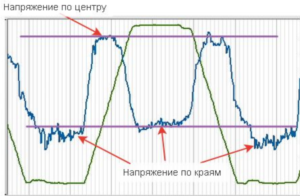
Рисунок 3 – Сигналы напряжения на дуге (синий) и поперечного положения сварочной горелки (зеленый)
