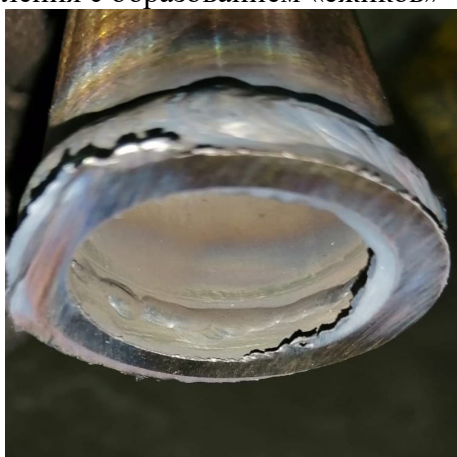
Рисунок 1 – Фото корня шва при обеспечении качественной защиты корня шва
