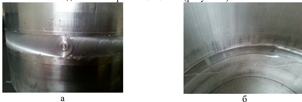
Рисунок 1 – Соединение труб из алюминиевого сплава 6063 размером \varnothing 156/3 мм методом СТП: (а) вид снаружи; (б) вид изнутри.
