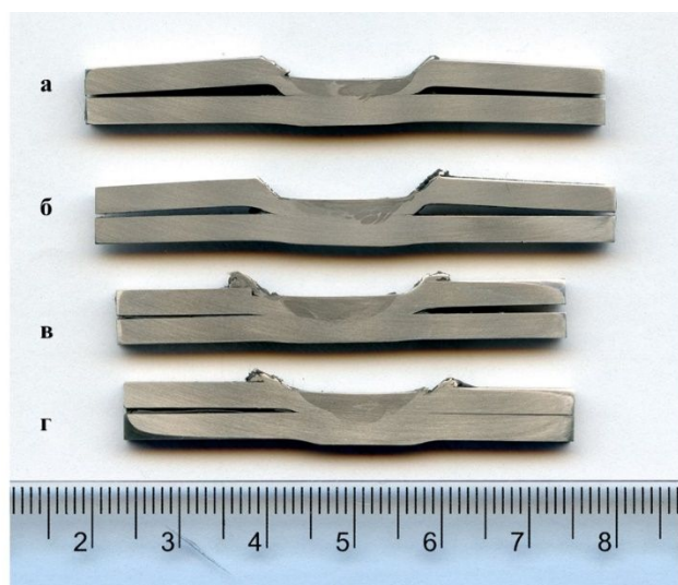
Рисунок 3 – Соединения, полученные СТП после: (а) – 2 проходов, (б) – 4 проходов, (в) – 10 проходов, (г) – 20 проходов
