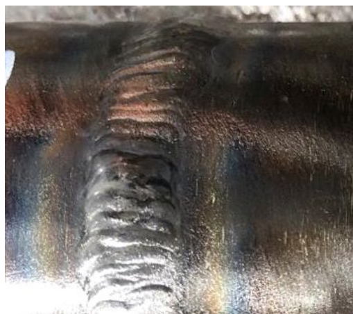
Рисунок 4 – Внешний вид сварного соединения , выполненного РАД (положение П1)
