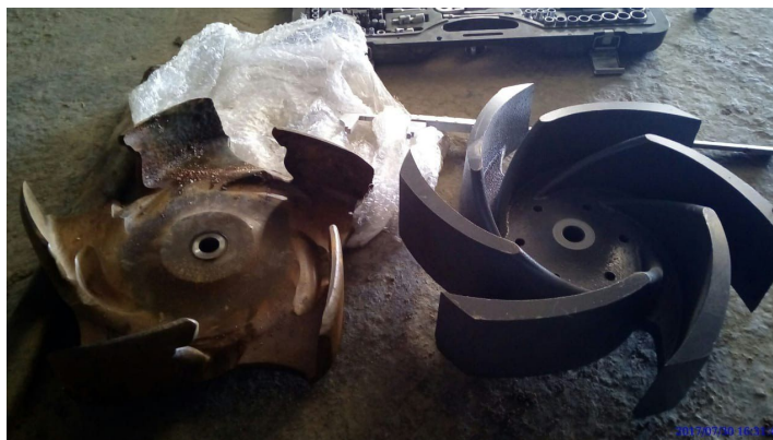
Рисунок 1 - Изношенный и новый шнек
