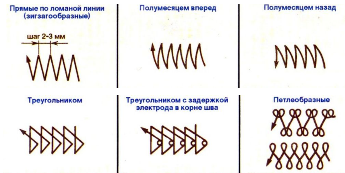
Рисунок 1 – Виды колебательных (поперечных) движений конца электрода
