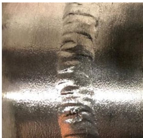
Рисунок 3 – Внешний вид сварного соединения , выполненного РАД (положение В1)
